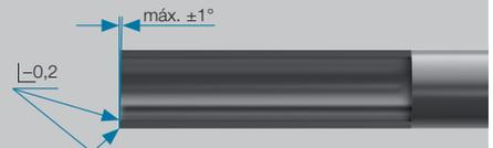
**2.3** Eliminar ligeramente las rebabas en los extremos del tubo, por el interior y el exterior. Limpiar el tubo.
