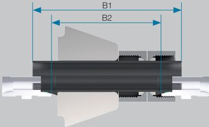
Longitudes mínimas para la sujeción de tubos acodados ( $R \geq 3x$  diám. ext. tubo).
