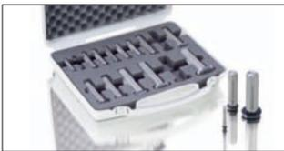
Las piezas de conexión para premontajes VOSS en su versión básica para anillos cortantes tienen tolerancias menores que las piezas normales para uniones roscadas y son más resistentes al desgaste. Pero también aquí es necesario el control: la calibración del cono interior de la pieza tiene que ser revisado al menos cada 50 premontajes. Los calibres de conicidad VOSS están perfectamente adaptados para ello, tanto individualmente como en juego completo para todos los tamaños.
