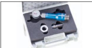
Los calibres de control VOSS permiten realizar con mayor celeridad los controles de calidad en los premontajes con anillos cortantes en la producción en serie y en la entrada de mercancías. Solo hay que colocar el extremo del tubo (6-42 mm), apretar con la fuerza de la mano y leer el resultado. Y para terminar un control visual adicional del material levantado en el anillo de corte.
